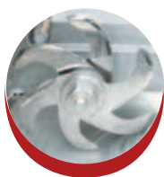
Couteaux réglés à 1 mm de la cuve Blade adjusted to 1mm from the bowl
