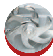
Tête avec 6 couteaux Head with 6 knives
